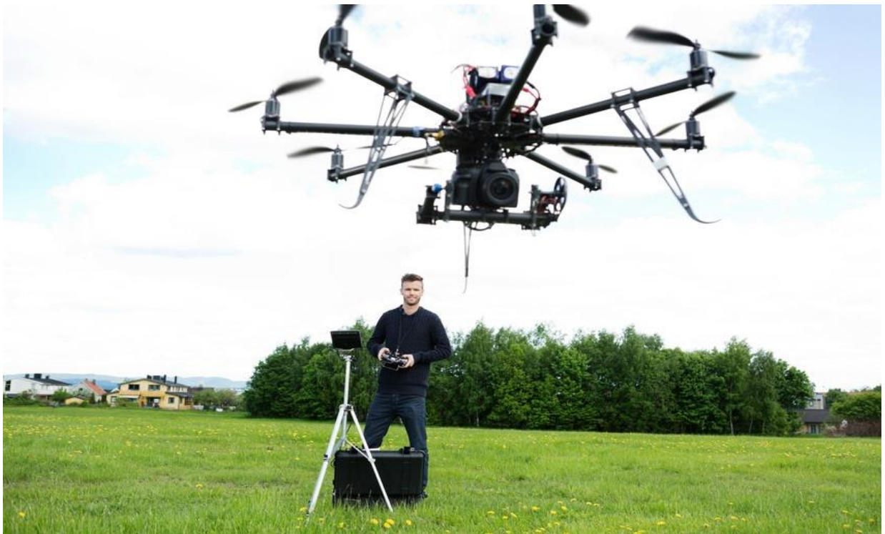
Dron – tzw. „wirnikowiec” do pomiarów fotogrametrycznych.
