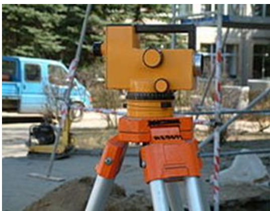
Niwelator „automatyczny” Ni 020A firmy Zeiss Jena na statywie – instrument służący do niwelacji Terenu
