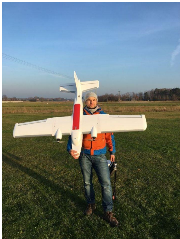
Dron – tzw. „płatowniec” do pomiarów fotogrametrycznych.
