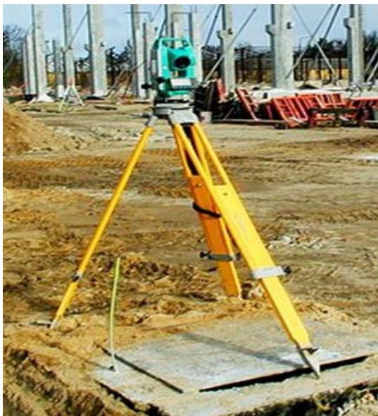
Tachimetr elektroniczny Sokkia umieszczony na statywie – instrument do pomiaru kątów i odległości
