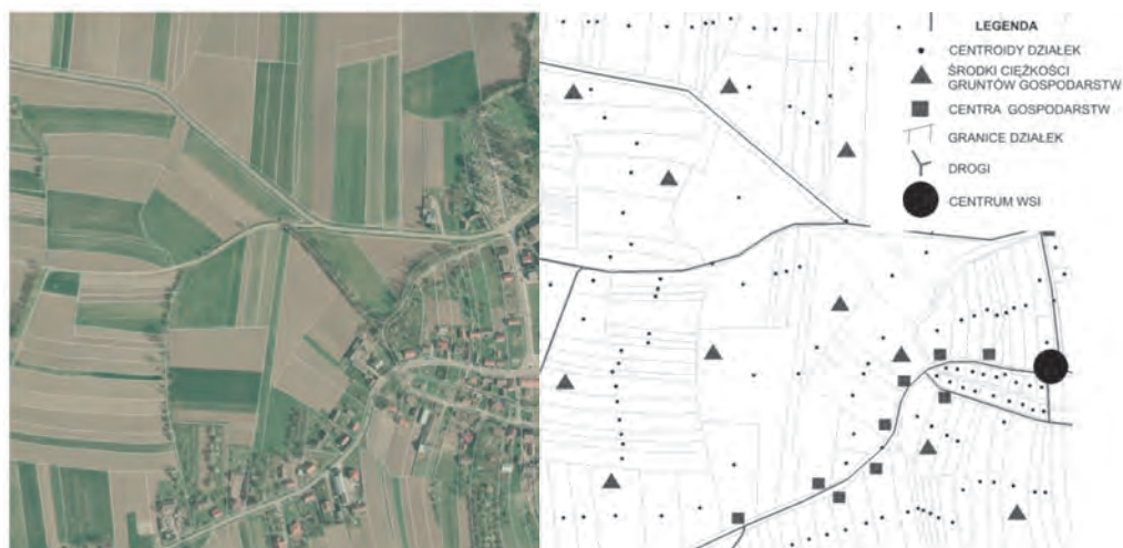
Ilustracja 4. Najważniejsze elementy uproszczonego modelu wsi utworzonego dla potrzeb oceny wpływu odległości na wartości parametrów rozdrobnienia gruntów (źródło: opracowanie własne na podstawie [Janus 2018])
