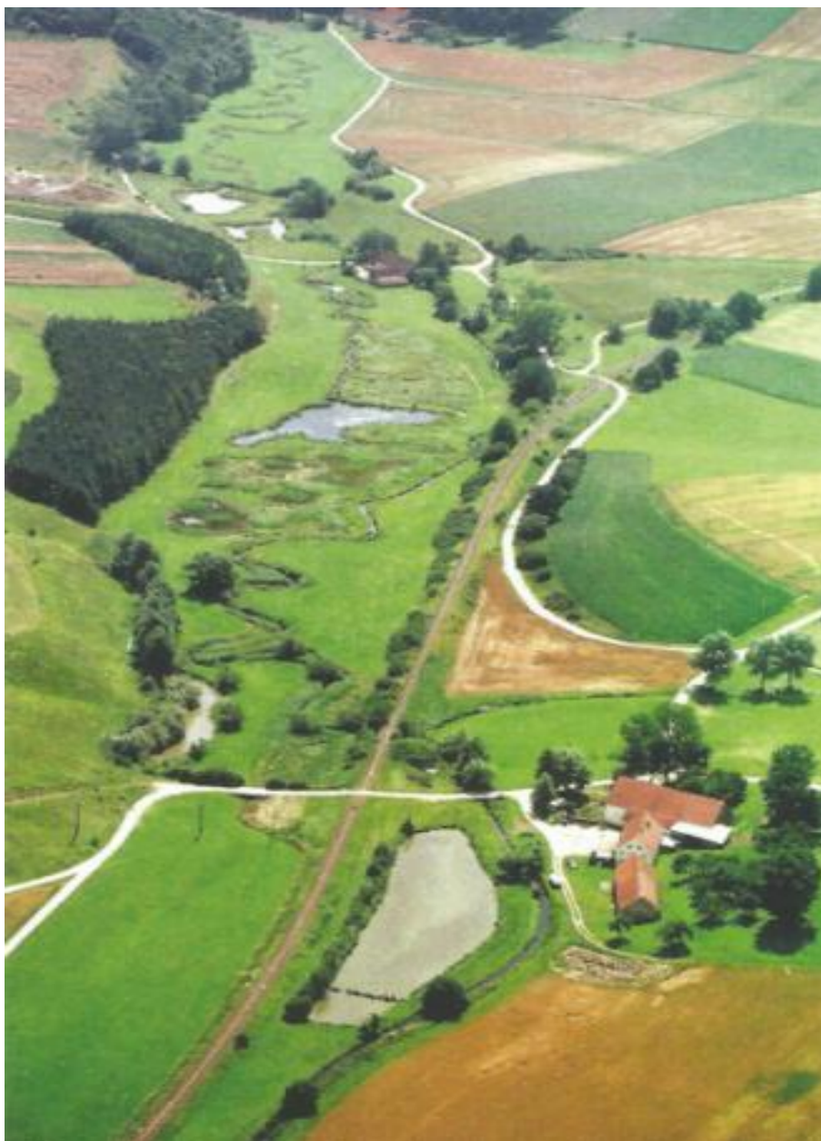
Ilustracja 10. Przykład wdrożenia funkcji retencyjnej i przeciwpowodziowej (meandryzacja cieku wraz z przyległymi terenami zalewowymi) oraz funkcji krajobrazowo-przyrodniczej (połączenie biotopów) za pomocą scalenia gruntów w Holandii, dzięki któremu możliwe było pozyskanie niezbędnego terenu. Na zdjęciu widoczna również wielofunkcyjna sieć dróg transportu rolnego zrealizowana w ramach zagospodarowania scaleniowego (źródło: ze zbiorów KGRKiF UR Kraków)
