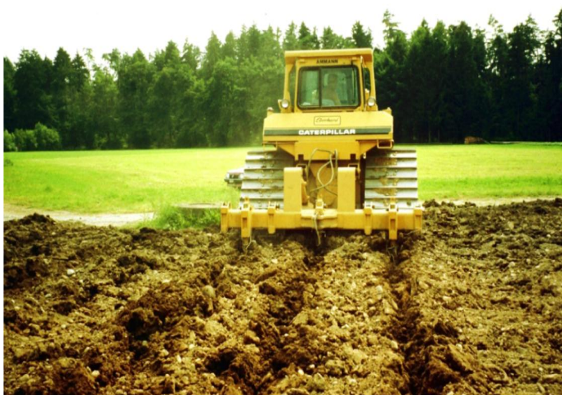
Ilustracja 24. Zwiększanie retencyjności gleby poprzez zabiegi agromelioracyjne – głęboszowanie
