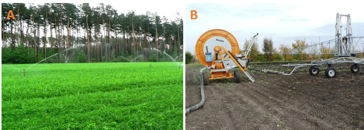
Ilustracja 27. Nawodnienia deszczownianie: A – deszczownia stała, B – deszczownia szpulowa
