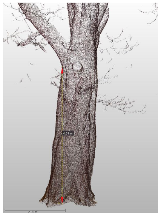
Ryc. 27. Pomiar wysokości drzewa i wysokości osadzenia korony na chmurze punktów.
