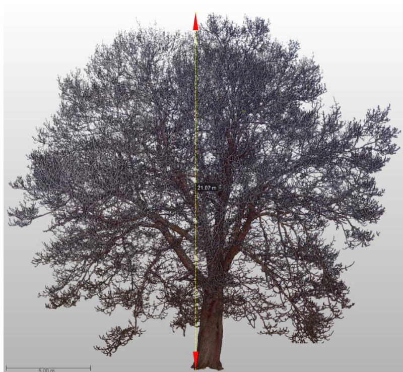
Ryc. 27. Pomiar wysokości drzewa i wysokości osadzenia korony na chmurze punktów.
