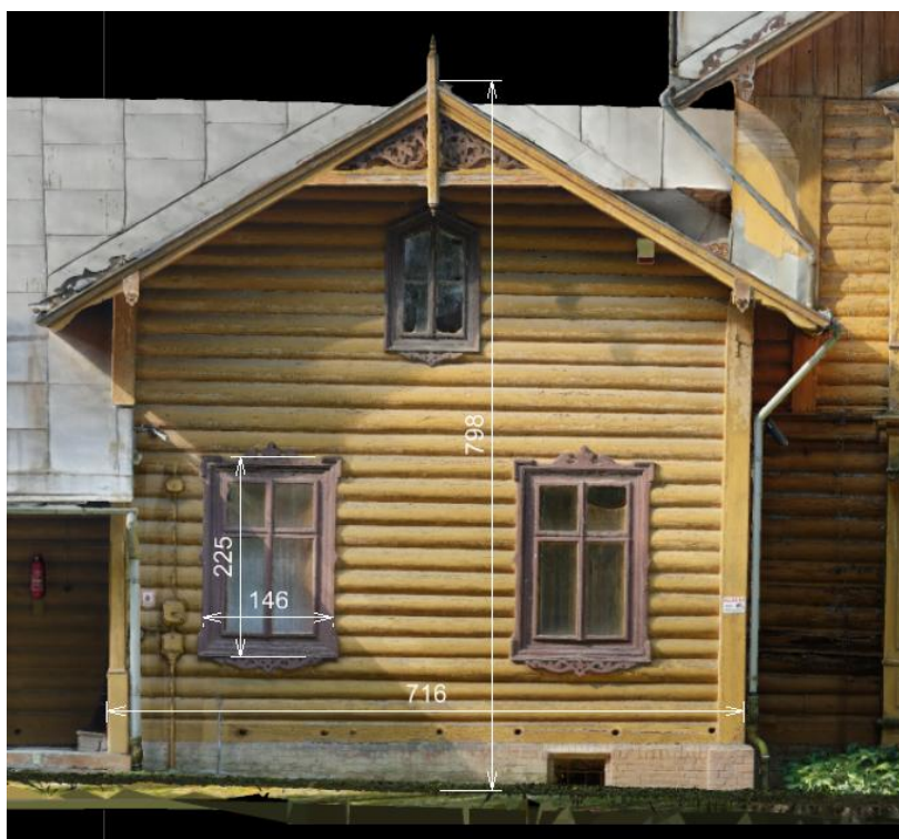
Ryc. 20. Pomiary na ortofotoplanie elewacji
